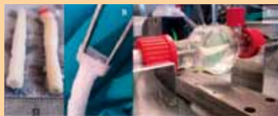
A: een poly(TMC) scaffold (links) vegeleken met een varkensarterie (rechts). B: flexibel en elastisch poly(TMC) scaffold. C: proefopstelling met laser micrometer om het gedrag van deze poly(TMC) scaffolds te bestuderen onder langdurige perfusiecondities.
